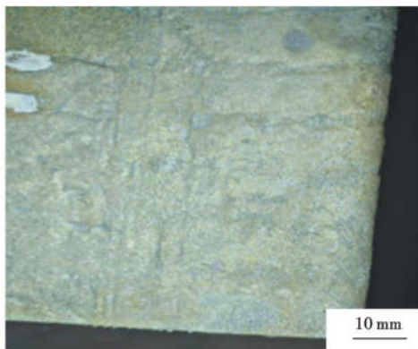
图 5 含 127 \times 10^{-6} \text{ N} 的 10B21 钢铸坯角部裂纹形貌 Fig. 5 Morphology of cast billet corner crack of 10B21 steel containing 127 \times 10^{-6} \text{ N}
